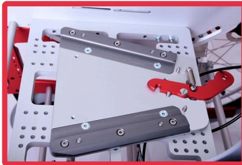
Die Aufnahmeplatte kann durch die vielen Löcher mit einer Trapez- oder einer anderen Aufnahme für die Sitzschalenfixation ausgerüstet werden.
